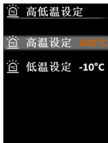
进入设定页面一级菜单后，选中高低温警报设定选项，点击SET键，进入“高低温设定”子菜单，用户可以自定义高低温警告阈值，如上图所示，通过上/下键选择选项，当选中“高温设定”或“低温设定”选项时，点击SET键，进入设定状态，通过上/下键调节温度参数，设置完之后按SET键退出设定并保存，然后点击返回键退出“高低温设定”子菜单，返回到设定页面一级菜单。
