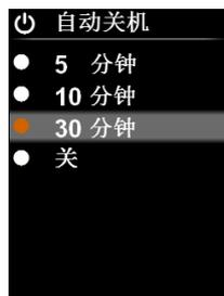
进入设定页面一级菜单后，选中自动关机选项，点击SET键，进入“自动关机”子菜单，如上图所示，通过上/下键选择时间参数，系统预设 5分钟、10分钟、30分钟、关四项。选中后点击SET键选中所需时间参数选项，然后点击返回键退出“自动关机”子菜单，返回到设定页面一级菜单。
