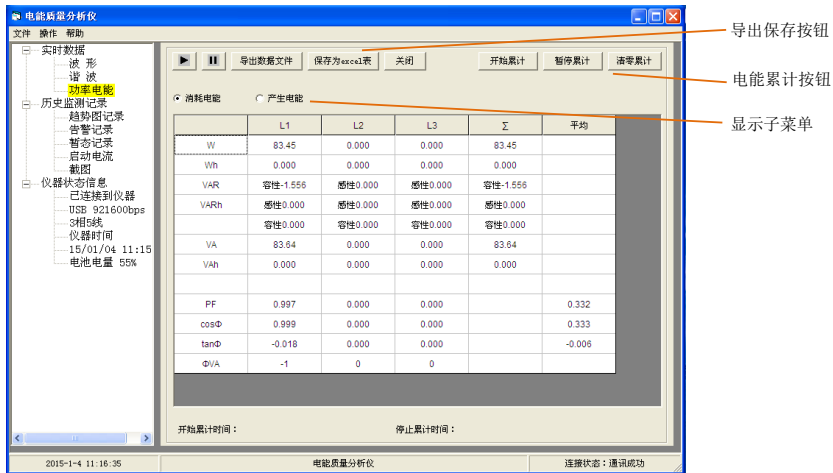
图 4-3 实时数据的功率电能显示
