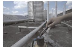
开机选中磁场检测模式，此时黄灯常亮，将测电笔笔尖靠近正常工作的电磁阀，当检测到磁通量大于5mT时，笔尖里的红黄双色指示灯的黄灯常亮，蜂鸣器慢响报警。证明电磁阀工作正常。
