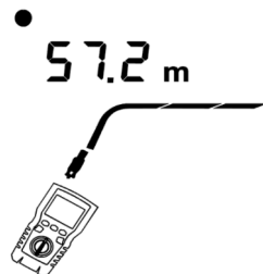
图6.15: 同轴电缆布线中存在开路
