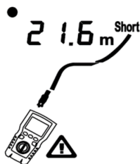
图6.16: 同轴电缆布线中存在短路
