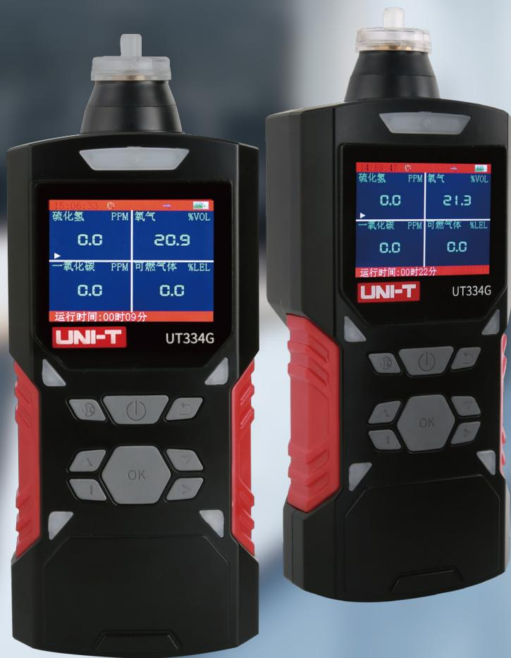
UT334G是一款四合一泵吸式语音型气体检测仪,是一种可连续使用检测泄漏有害气体浓度的安全型设备。采用了先进的集成电路技术、32位嵌入式微机芯片控制,内置超高分辨率ADC检测专用芯片。计算速度更快,测试数据更精确稳定。检测仪使用2.4英寸高清液晶彩色屏幕,中英文界面和中英文语音提示,USB充电接口,内置5000mAh大容量锂电池及高端真空吸气泵,优质的进口气体传感器,具有优秀的灵敏度和出色的重复性;反应速度快、抗干扰能力强,性能稳定可靠。
