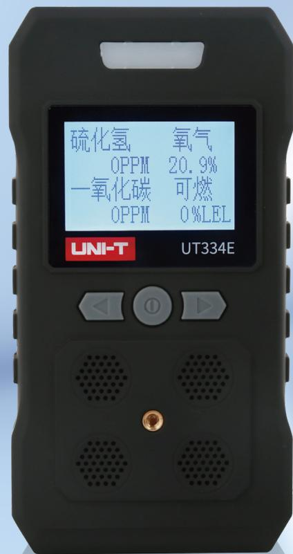
UT334E是一款便携式语音型四合一气体检测仪,是一种可连续检测泄漏气体浓度的安全型设备。采用了先进的集成电路技术、嵌入式微机控制,优质的气体传感器,具有优秀的灵敏度和出色的重复性;使用点阵式LCD显示器,支持中英文界面和中英文语音提示,使用及维护简单;外壳采用高强度工程塑料,抗振好,强度高,并具有防爆功能。
