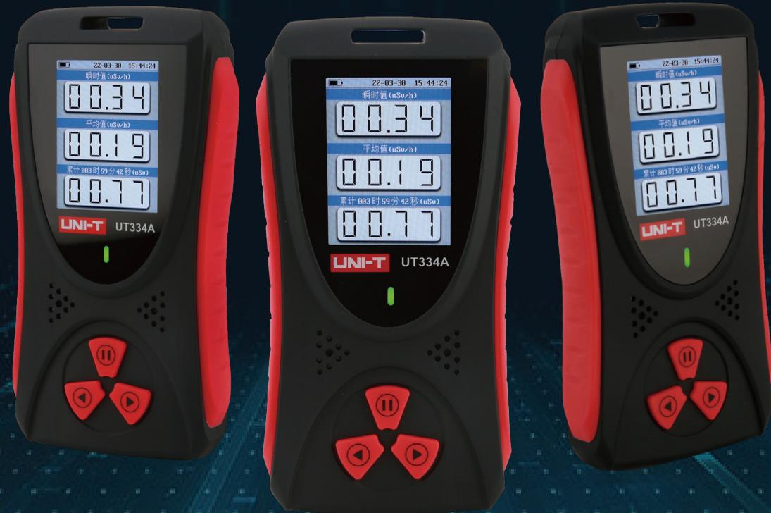
UT334A是一款小型高灵敏度的辐射剂量报警仪,主要用来监测X射线,β射线和γ射线。具有灵敏度高,测量准确等特点;选用了性能强劲的微处理器,配备了TFT2.0彩色屏幕,使操作简便人性,具有很强的抗干扰能力。声音、闪光两种报警方式任意组合,且报警阈值可任意设定,当达到报警阈值时,发出警报及时提醒工作人员注意安全。
