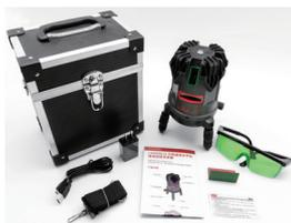
本产品采用波长为510nm-515nm的半导体激光,激光线条清晰明亮,自带强光点,水平仪可以产生五个激光扇面和一个下对点。激光扇面投射到墙面上,产生一条水平线和四条垂直线,相邻的两条垂直线夹角均为90°,其交点即为仪器的天顶。
