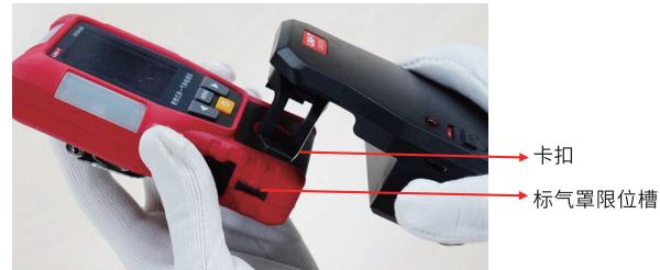
2.对准后, 将采样泵稍稍用力按压下去, 待泵和传感器检测处完全紧密合后听到“咔”的一声且泵固定不摇晃开机即可使用。
