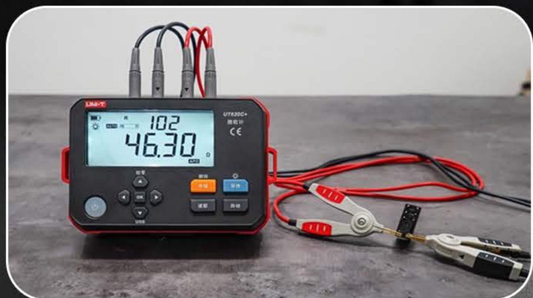
继电器接触点电阻测量
