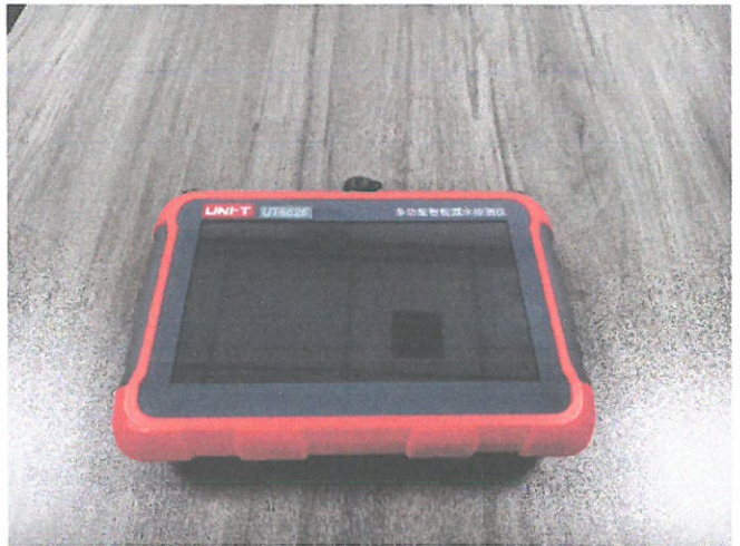
图3.2-2 多功能智能漏水检测仪（主机）外观图
