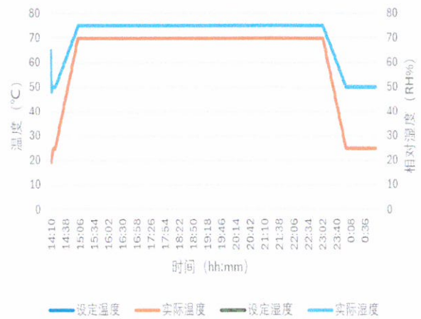
图5.3-2 受试样品湿热(贮存)试验温度曲线图
