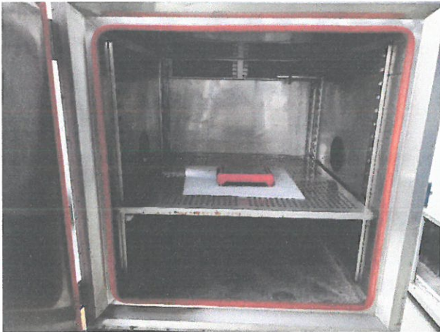
图5.2-1 受试样品低温工作试验摆放图
