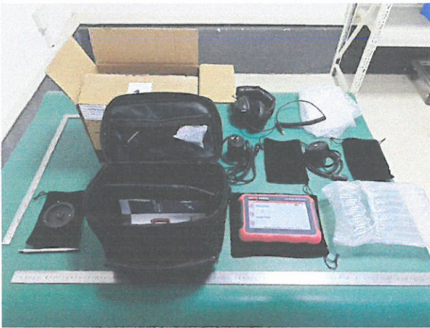
图3.2-1 多功能智能漏水检测仪（整机）外观图
