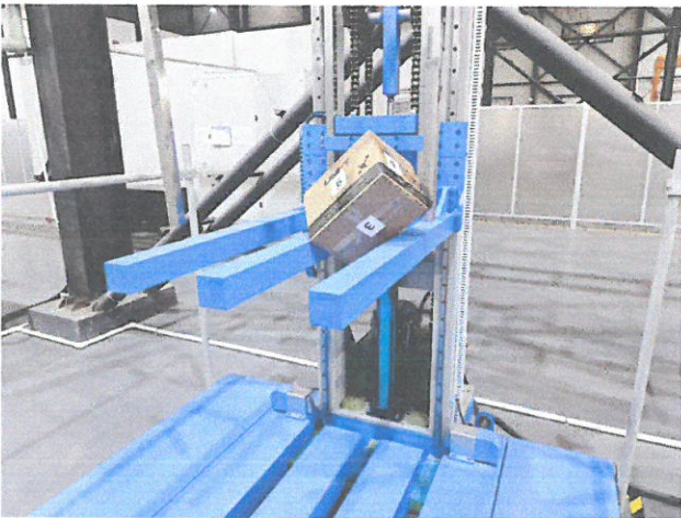
图5.4-3 受试样品跌落试验（角跌落）摆放图
