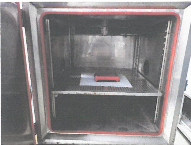
图5.3-1 受试样品湿热(贮存)试验摆放图
