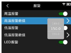
当被测物温度超过高温报警温度值时，弹出红色正三角的提示；当被测物温度低于低温报警温度值时，弹出绿色倒三角的提示。
