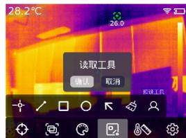
注意：点测温分析对象最多添加5个，线测温分析对象只能添加1个，矩形和圆形测温分析对象最多可以添加3个。添加的总测温分析对象数量不能超过6个，当超过6时则不再添加分析对象，并弹出提示“超出工具数目”。
