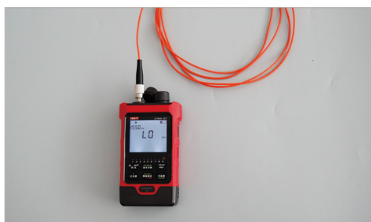
光纤跳线通断检测
